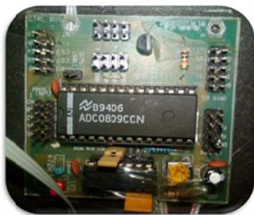
(sumber : Perencanaan & Implementasi) Gambar Rangkaian ADC
