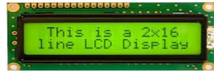
Gambar 2.7 Modul LCD Karakter 16x2
