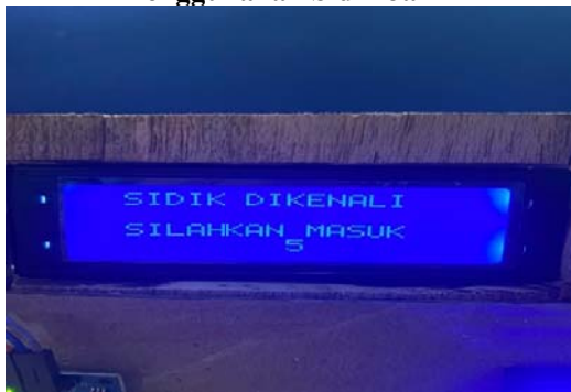
Gambar 11. Tampilan LCD Jika Sensor Sidik Jari Menerima Sidik Jari Yang Terdaftar
